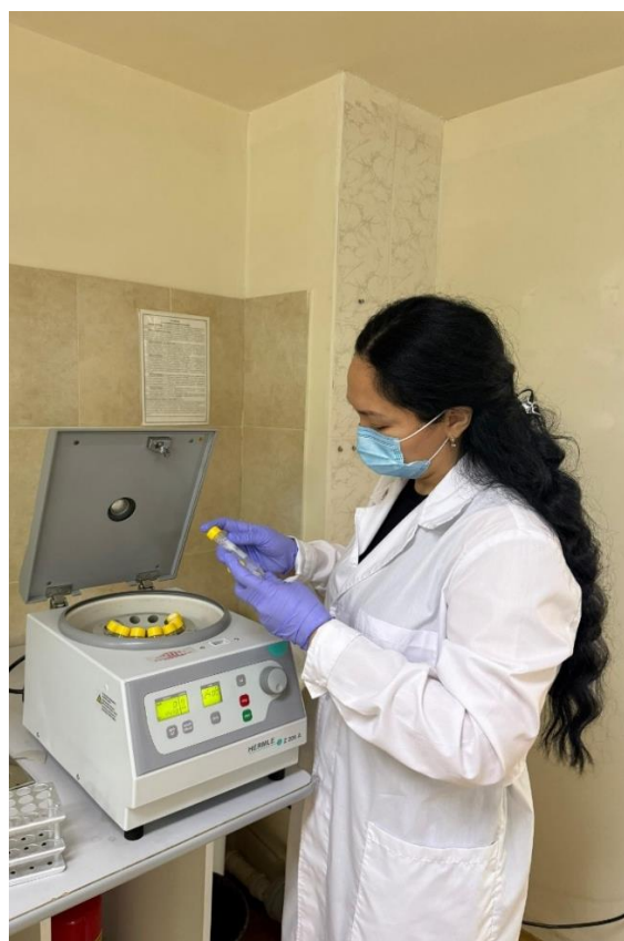
Сурет 2.6 -Сынамаларды талдауға дайындау кезеңі: масс-спектрометрлік талдауға арналған зәр үлгілерін центрифугалау
